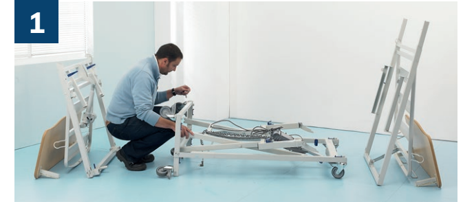
TRANSFORMATION du chariot autoportant en châssis.
